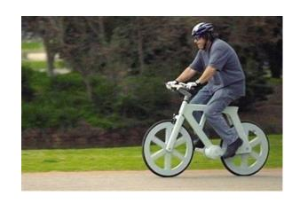
这款自行车名为"阿尔法",是机械工程师伊扎尔·加夫尼的智慧结晶。自行车重9公斤,生产成本大约16美元。"阿尔法"线条简洁,颇具时尚气息。车子全部由可回收材料制成,除了刹车和链条,其他部分都是硬纸板。
